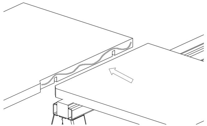
Sous le plan de travail, positionner et assembler les ferrures d'assemblage fournies
